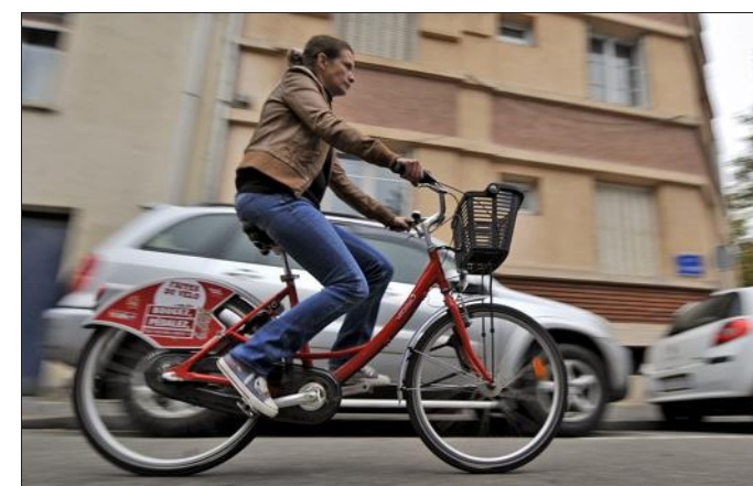
■ Les Vélostan rouge ont deux systèmes d'antivol : une mâchoire dans la roue arrière et un « U ».
